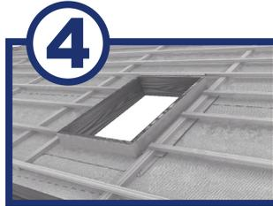
Preklapanja, otvori ili oštećenja na membrani **Ursa** moraju biti sanirani uz pomoć odgovarajuće samolepljive trake. Za spajanje s elementima krova upotrebljava se krovno birtvilo ili butilna traka.
